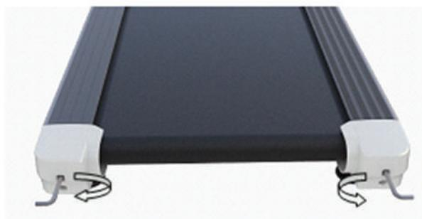
Обратите внимание, что вращение обоих регулировочных винтов должно осуществляться на одну и ту же величину. Рекомендуется поворачивать регулировочные винты только на 1/8 оборота каждый раз во избежание перетяжки бегового полотна, т.к. перетянутое полотно может вызвать повреждение деки.
