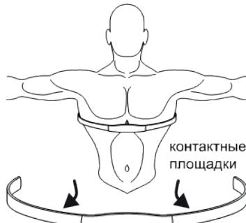
Для более качественного измерения рекомендуем вам перед началом тренировки немножко увлажнить контактные площадки водой или специальным электропроводящим гелем. Не используйте для этого вазелин и маслосодержащие кремы или жидкости, так как они могут иметь изолирующие свойства, препятствующие снятию импульсов с кожи.
