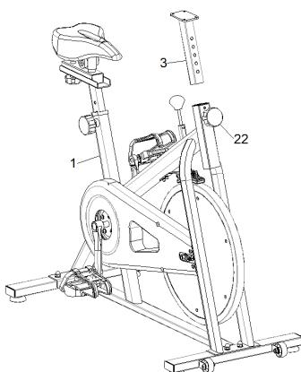
Ослабьте ручку регулировки (22) и вставьте деталь регулировки руля (3) в основную раму (1). Убедитесь, что отверстие расположено на одном уровне с ручкой регулировки (22), и затяните ее (22).
