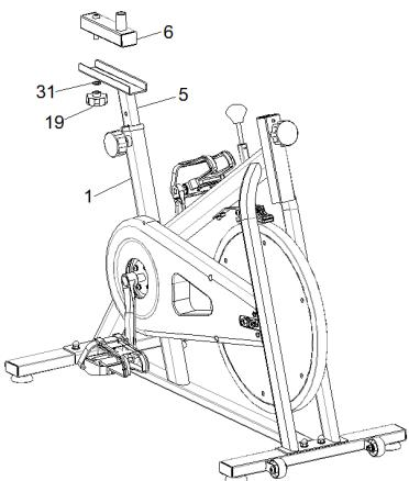
Закрепите соединительную деталь сиденья (6) в детали регулировки сиденья (5). Болт, приваренный к соединительной детали (6), должен оказаться в пазу детали регулировки сиденья (5). Зафиксируйте его с помощью гайки (19).
