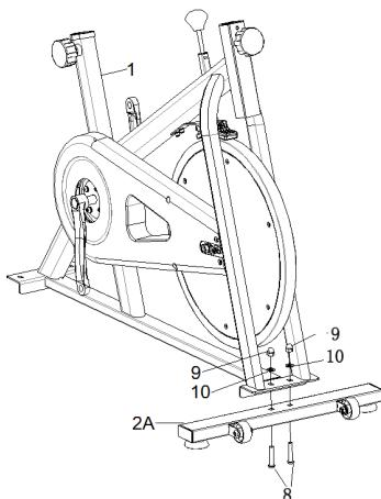
Закрепите передний стабилизатор (2A) на основной раме (1), используя 2 комплекта каретных болтов (8), купольных гаек (9) и шайб (10).
