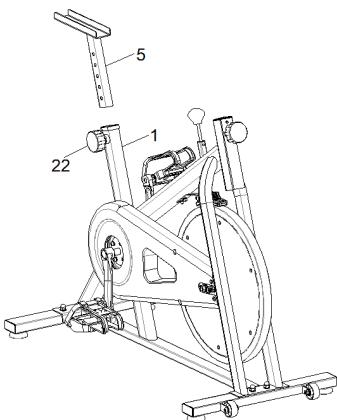
Ослабьте ручку регулировки (22) и вставьте деталь регулировки сиденья (5) в основную раму (1). Убедитесь, что отверстия лежат на одной прямой, и затяните ручку регулировки (22).
