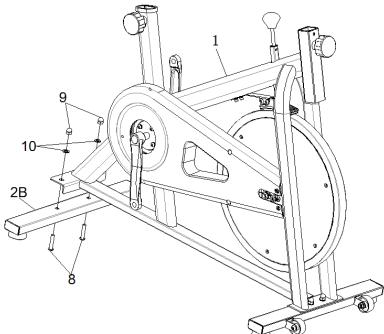
Закрепите задний стабилизатор (2B) на основной раме (1), используя 2 комплекта каретных болтов (8), купольных гаек (9) и шайб (10).
