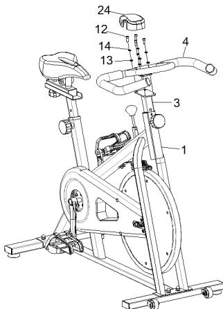
Соедините руль (4) и деталь регулировки руля (3). Убедитесь, что отверстия совпадают полностью. Надежно скрепите детали 4 комплектами шестигранных болтов (12), шайб (13) и пружинных шайб (14).
