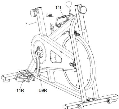
Вставьте правую педаль (11R) в коленчатый вал (59R) и закрепите, вращая ПО ЧАСОВОЙ СТРЕЛКЕ. Закрепите левую педаль (11L) в коленчатом вале (59L), вращая ПРОТИВ ЧАСОВОЙ СТРЕЛКИ. Используйте гаечный ключ (20) для надежной фиксации крепления.
