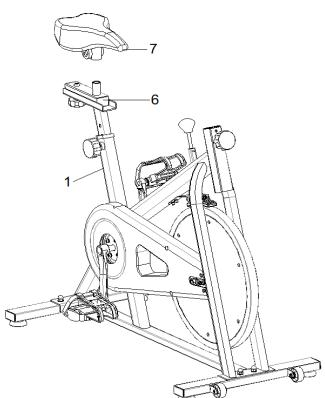
Наденьте сиденье (7) на соединительную деталь (6). Плотно зафиксируйте его, затянув две гайки под сиденьем (7).
