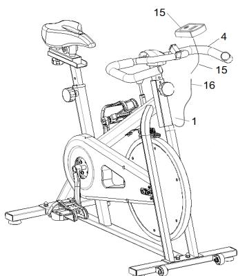
Закрепите компьютер (15) на руле (4) движением вдоль выступа на руле (4). Затем вставьте провод от датчика (16) в разъем компьютера (15).
